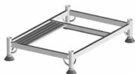
STAPELPALETTE FÜR ROHRE Besonders für Modulgerüste geeignete Palette für Stiele, Riegel, Geländer, Diagonalen, Rohre und Bordbretter. Allseitig offen, Stapler- und Krantransport geeignet. Die Aufsteckrohre sind entnehmbar und im Grundrahmen gesichert verstaut, sodass die Leerpalette sehr platzsparend transportiert und gestapelt werden kann. Stahlrohr, feuerverzinkt.
